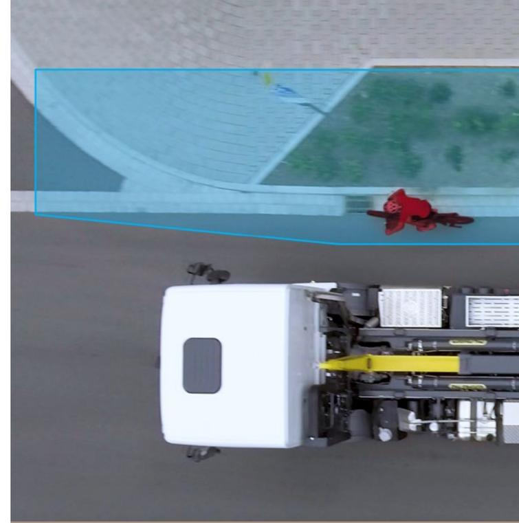
Über das LED-Display an der A-Säule wird der Fahrer optisch gewarnt. Bei aktiviertem Blinker erfolgt zusätzlich eine akustische Warnung.
